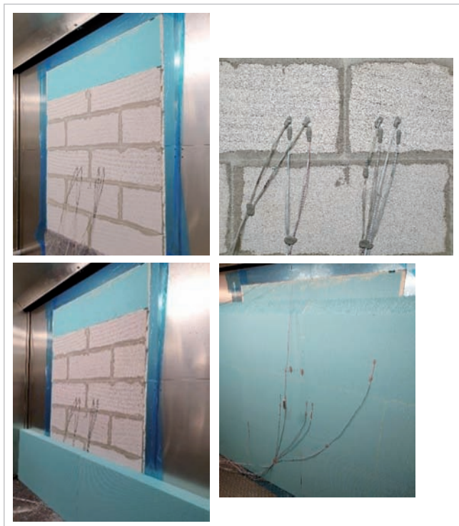
Obr. 3 Stena s tepelnou izoláciou osadená v komore – pohľad z exteriérovej komory
